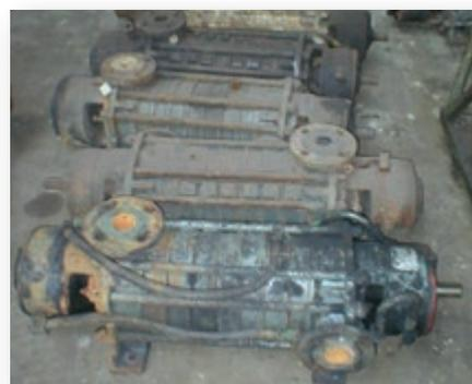
Элементы ремонтируемых насосов проходят гидростатические испытания; по желанию Заказчика выполняются измерения рабочих параметров в требуемом диапазоне производительности. Измерения параметров выполняются с классом точности 1 или 2, согласно стандарту PN-EN ISO 9906, на одном из измерительных стендов.
